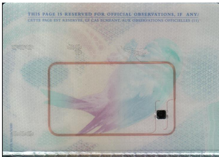
Fot. 3. Umiejscowienie RFID w dokumencie paszportowym
