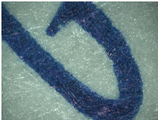
Fot. 7. Zapis wykonany długopisem żelowym, który nie przeszedł przez drukarkę laserową – powiększenie 50x.
