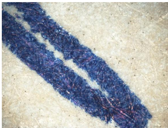
Fot. 8. Zapis wykonany długopisem żelowym, który przeszedł przez drukarkę laserową – powiększenie 50x.
