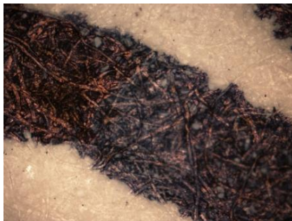
Fot. 11. Zapis wykonany piórem wiecznym, który przeszedł przez drukarkę laserową – powiększenie 100x.
