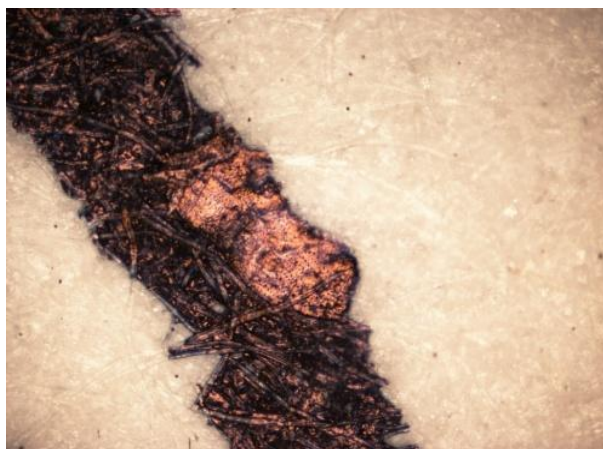
Fot. 10. Zapis wykonany piórem wiecznym, który przeszedł przez drukarkę laserową – powiększenie 100x.
