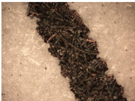
Fot. 6. Zapis wykonany piórem wiecznym, który przeszedł przez drukarkę laserową – powiększenie 100x.
