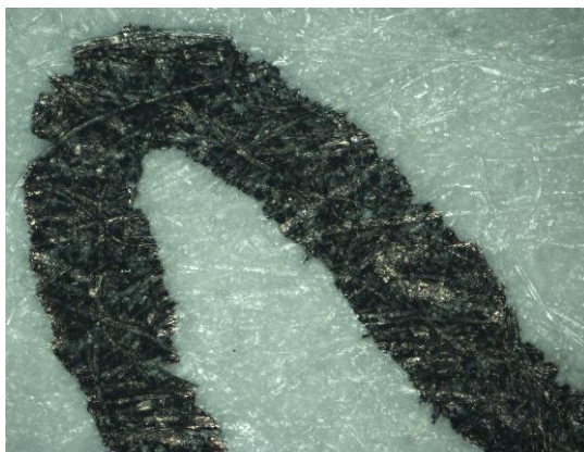
Fot. 1. Zapis wykonany piórem wiecznym, który nie przeszedł przez drukarkę laserową – powiększenie 50x.
