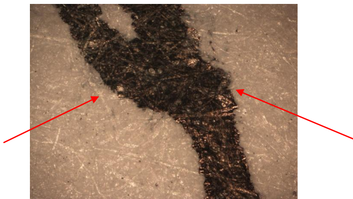
Fot. 2. Zapis wykonany piórem wiecznym, który przeszedł przez drukarkę laserową – powiększenie 50x.
