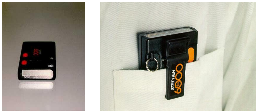
Rys. 14. Dozymetry typu R.A. STEPHEN SERIA 6000
