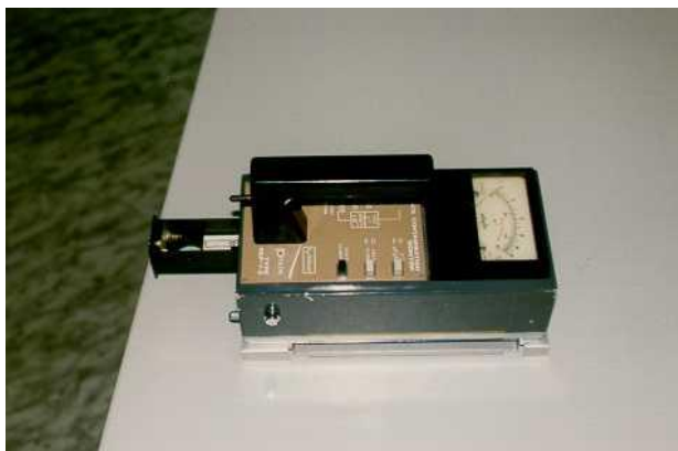
Rys. 11. Monitor skażeń powierzchni typu RKP-1-2
