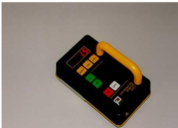
Rys. 10. Monitor skażeń typu EKO-C
